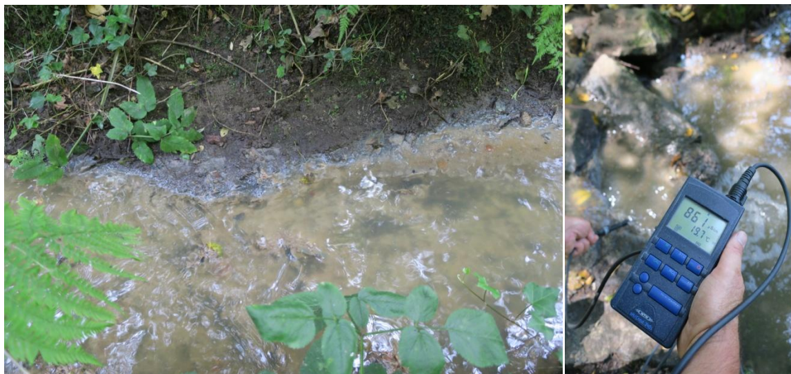
Figure 31 : Dégradation de la qualité chimique d'un affluent du Scave (en juillet 2018) liée au dysfonctionnement d'un poste de refoulement situé en amont
